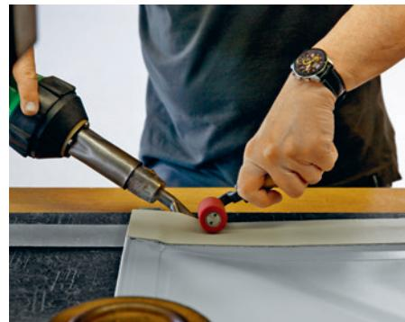
Die Verstärkungen aus weichem PVC-Material werden an der Unterseite der Abdeckung aufgeschweisst.
